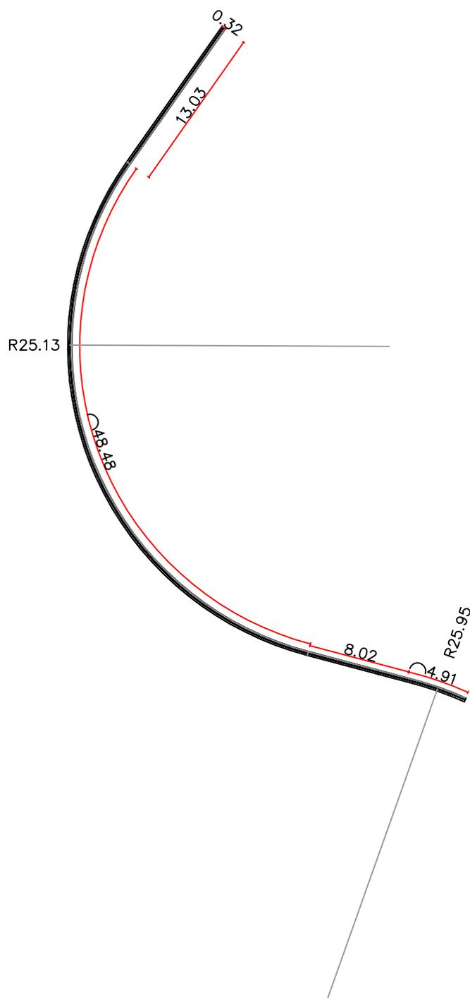
$\overset{\frown}{2.89}$  圆弧中心线尺寸标注
